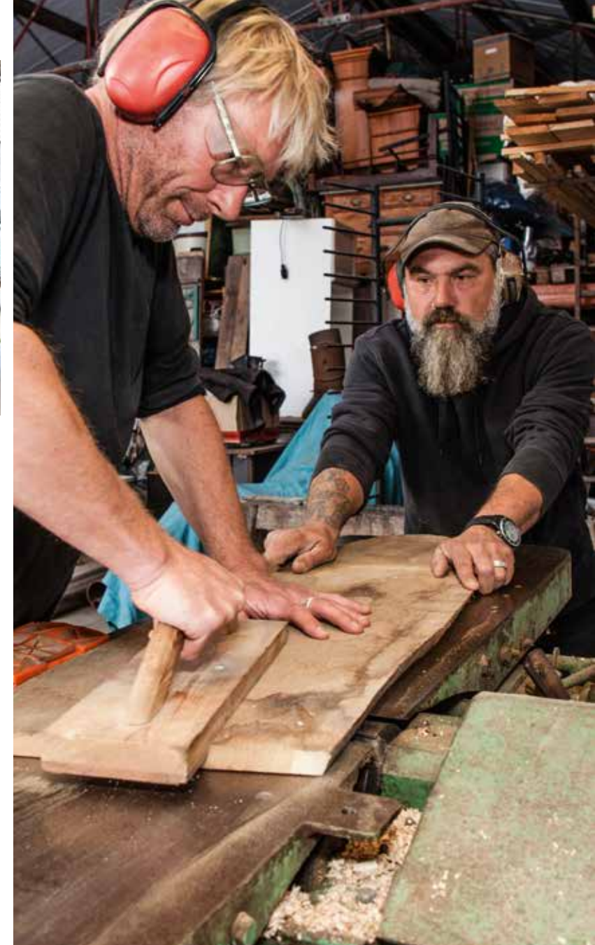
Die Fassade der Häuser ist aus Europäischer Lärche. Die Bretter werden alle selber zugesägt und gehobelt.
